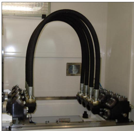
Il sistema di movimentazione del manifold consente di effettuare le seguenti traiettorie: alto / basso; destra / sinistra; cerchio; "8"
